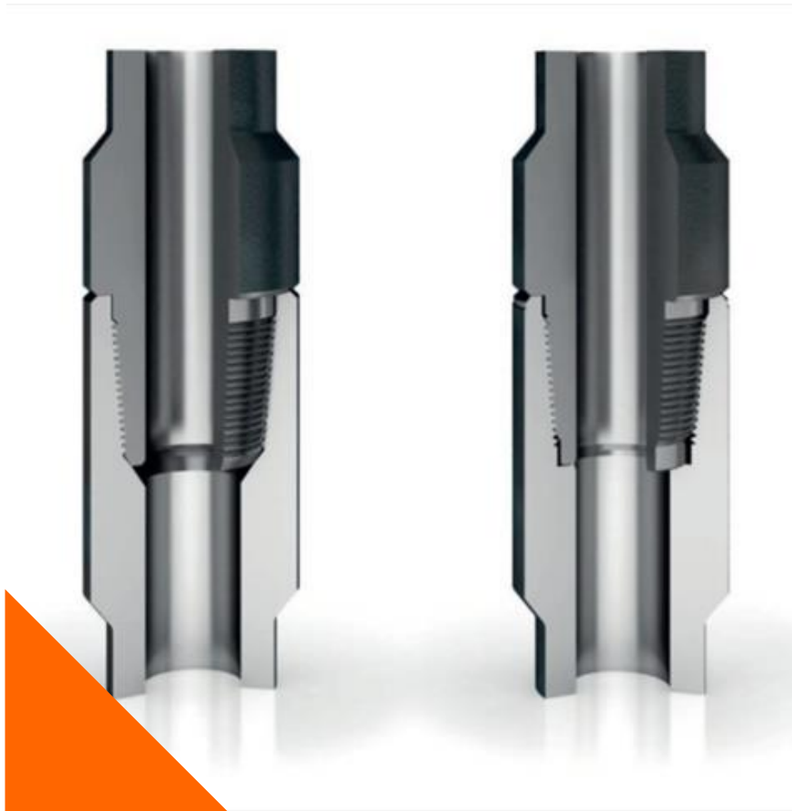
Рис.3 – Сравнительное 3-d изображение замка с двухупорной резьбой и замка по ГОСТ 27834-95
