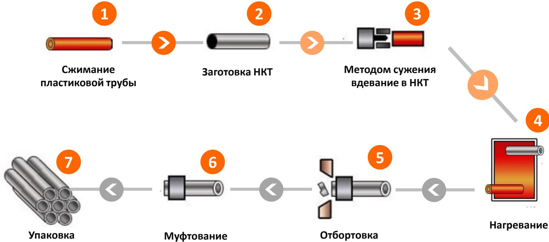
НКТ с футеровкой EXPE изготавливается путем нанесения покрытия на внутреннюю стенку с технологией, обеспечивающей надежную адгезию внутреннего покрытия с корпусом НКТ.
